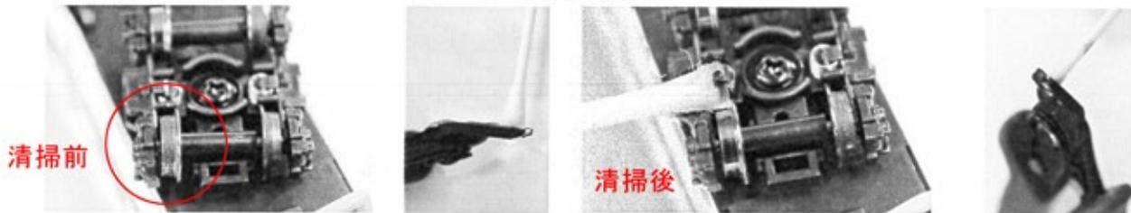
車輪踏面に金属光沢が確認でき、綿棒に汚れが付着しなければ清掃完了です。
